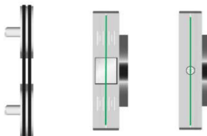
Рис. 9. Оптимально выровненные шкивы
