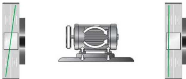
Рис. 6. Смещение по вертикали до и после регулировки
